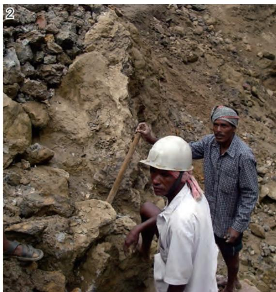
写真2 アパタイトの採掘は手作業で行われている。手前から奥に伸びる白い鉬体がアパタイト鉬体。鉬体は南に75度傾斜する。割れ目に棒をねじ込んで鉬石を採掘している。
