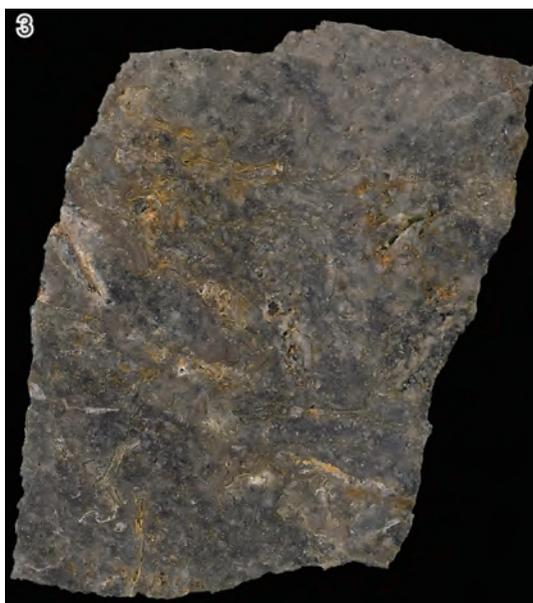
写真3 高品位アパタイト鉬石写真。アパタイトを主体として若干の黄鉄鉬や磁鉄鉬を少量含む。やや黒ずんだ色を呈する。写真幅は約6.5cm。
