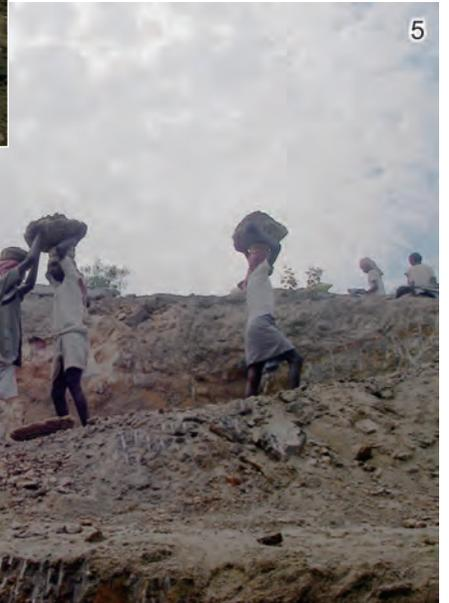
写真5 鉱石は頭に乗せて運び、バケツリレーのように、短い距離で受け渡しを行ないながら鉱石を運搬する。
