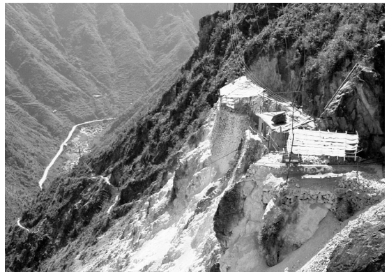
写真3 ろう石鉱床。採掘されたろう石は坑口から索道で遙か下の道路へ下ろされます(1985年当時)。
