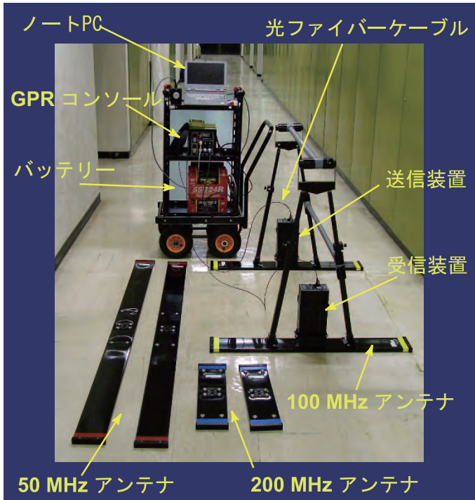
第4図 我々が保持するGPRシステム、Sensors & Software Inc. Pulse EKKO 100 (Canada)をカスタマイズして使用している。
