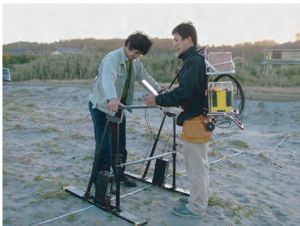
第2図 千葉県九十九里浜低地の現世海岸におけるGPR探査風景。起伏のある地形面ではBack packer typeが有効である。
