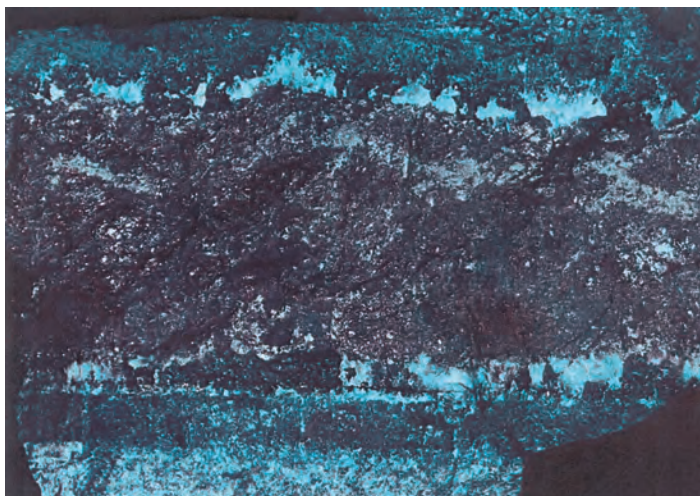
3. ユビレナヤ鉱脈の還元的鉱石。中央の大部分は磁硫鉄鉱、盤際にインジウム(In)を含む黒色閃亜鉛鉱-石英脈。
