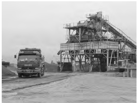
写真11 揖斐川沿いの砂利プラント。河川敷や田畑の下から採掘した砂を洗浄・選別している。
