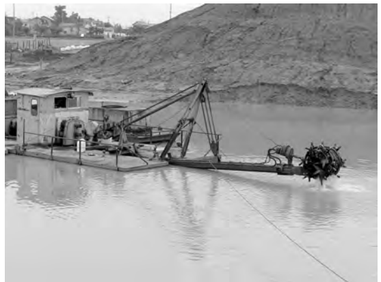
写真17 砂利採取舟。舳先の掘削装置の先端には高圧水で動く回転部があり、水底の砂利を掘削して吸い上げる。
