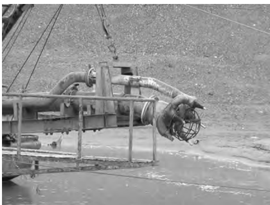
写真21 砂利採取船の舳先。舳先の掘削装置の先端には高圧水を噴射するノズルがあり、ジェット水流で水底の砂利を掘削して吸い上げる。
