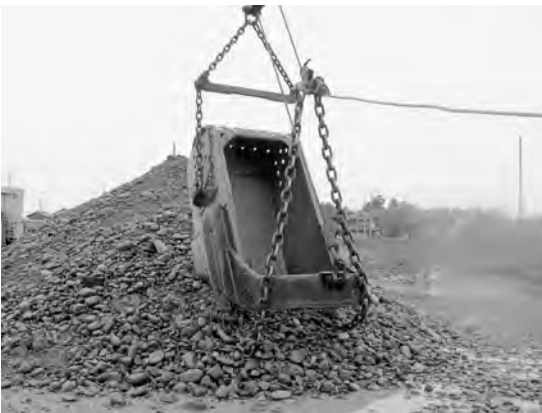
写真15 クラム・シェル。砂利をすくい上げるバケット、貝殻に似ていますか？
