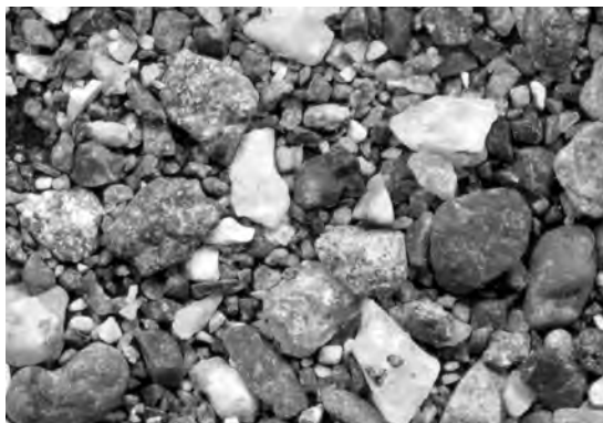
写真13 粕川系の砂利。画面左右が2cm。砂岩・頁岩片に、花崗岩片や石英・長石が混じる。
