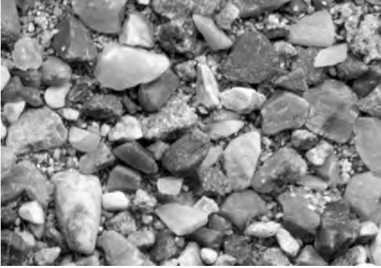
写真8 長良川の砂。河原の礫間に堆積した砂。画面左右が2cm。
