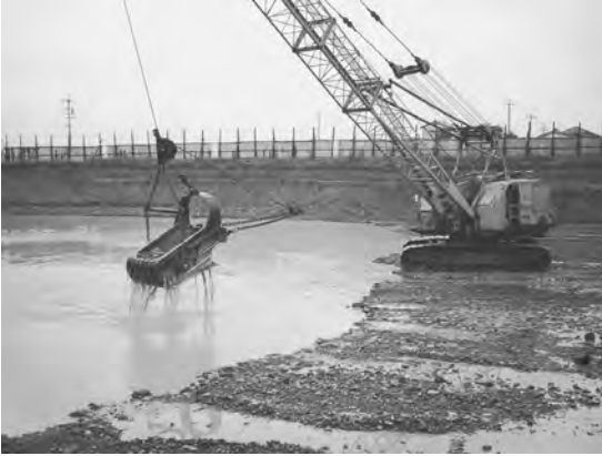
写真14 クラム・シェルによる砂利採取。扇状地の扇状部では湧水があるためにこの機材が便利。
