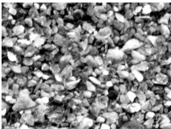
写真19 旧木曾川河道の砂。画面の左右が約1cm。現在の木曾川の砂(写真3)に酷似している。
