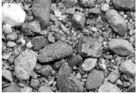
写真10 揖斐川の砂。河原の砂堆から採取した砂。画面左右が2cm。
