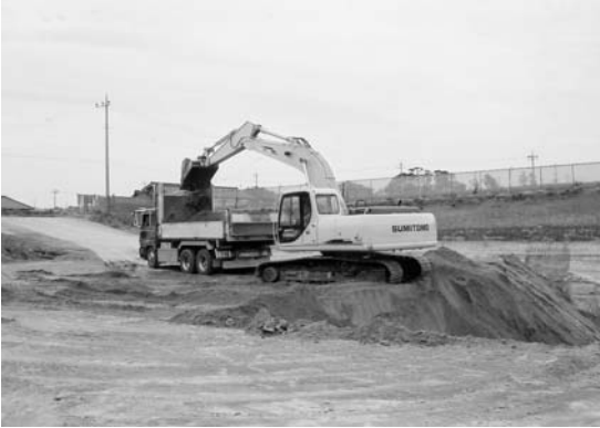
写真24 陸砂の採取. 重機により田んぼの一面が掘り下げられ, 砂が採取されている.
