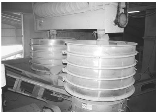
写真29 朝日興業(株)の精製工場。幾重にも重ねられた篩で砂を選り分けてゆく。
