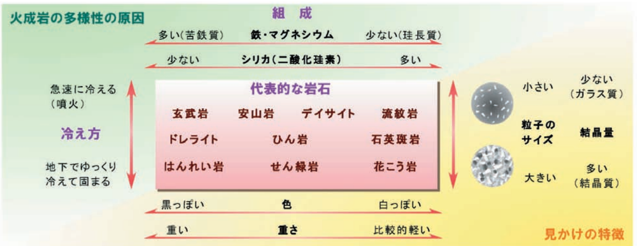
3. 火成岩の分類では、火成岩の多様性の原因を左上側に、その結果現れる見かけの特徴を右下にまとめてある。
