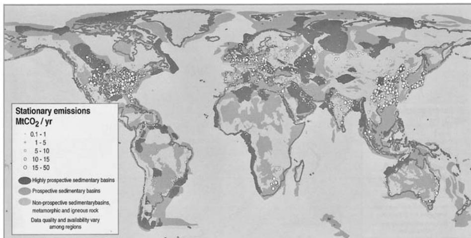
第6図 CO<sub>2</sub>の固定的な大規模排出源(白丸)と貯留に適した帯水層の分布 (IPCC, 2005). 丸の大きさは排出量に比例, 帯水層は貯留に好適なものほど濃色に表現されている. 日本周辺では中程度に有望な帯水層が分布するとされている.
