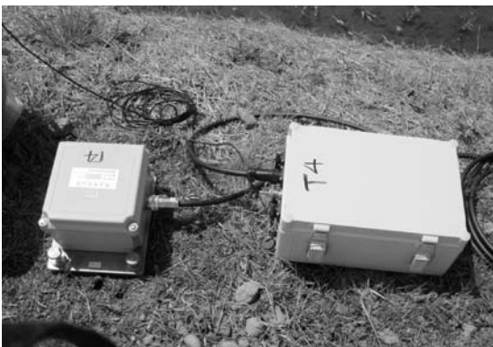
写真1 微動探査装置一式 (左側: 震動センサー, 右側: データ収録機器)。
