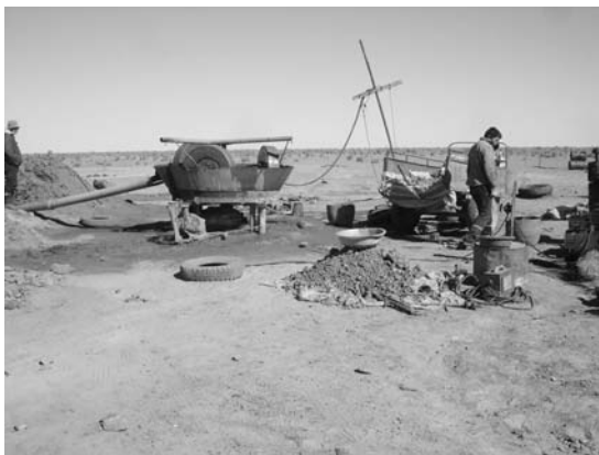
第21図 忍者の鉱石粉碎施設。ここで砕かれた試料はリーチングプールに運ばれる。
