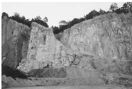
写真8 同採石丁場の採石切羽。 「灘山型」花崗岩の採石切羽には写真に見られるように随所に板状節理が発達し,不規則な岩脈に貫入されている。
