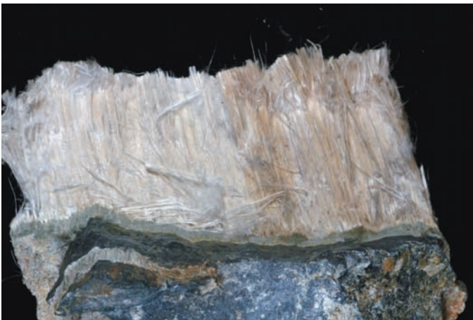
写真2 蛇紋石中の割れ目に成長したクリソタイルの平行繊維。絹糸光沢が美しい。 北海道野沢石綿鉱山 GSJ M16254 左右長12cm
