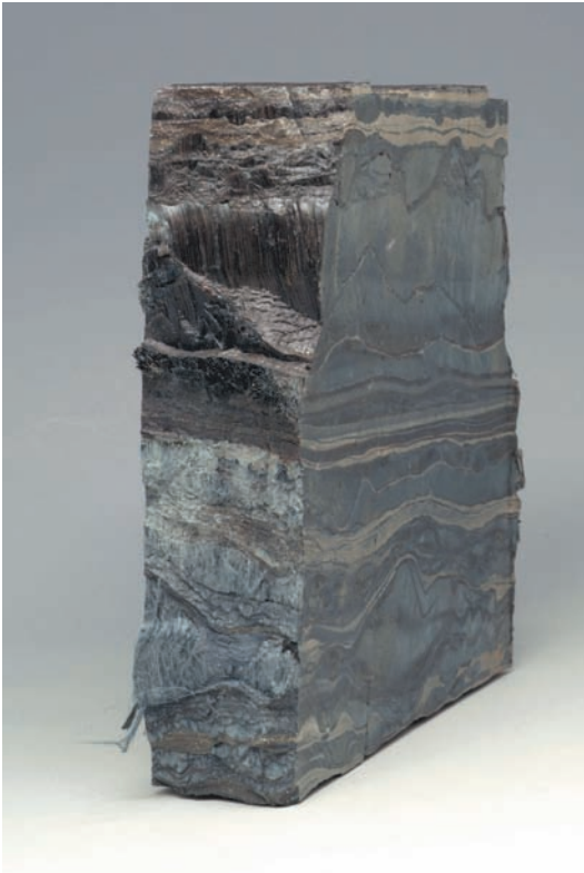
写真5 クロシドライト(青石綿)。 リヒター閃石の微細な繊維が濃集した変成岩。濃い青灰色を呈することから青石綿と呼ばれます。吸引により悪性の呼吸器障害を引き起こす可能性が高く、殺人アスベストの異名をもっています。 南アフリカ共和国ノーザンケープ州 GSJ M17900 標本高17cm
