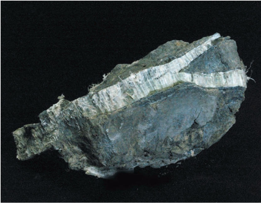
写真1 蛇紋石(暗色)中の割れ目に垂直に成長したクリソタイル(白色)の繊維。クリソタイルは蛇紋石族の層状珪酸塩鉱物ですが、シートが螺旋状に巻いて細い繊維をつくります。アスベストの中で消費量の最も多かったのがクリソタイルを主成分とする白石綿です。 北海道野沢石綿鉱山 GSJ M10071 左右長12cm
