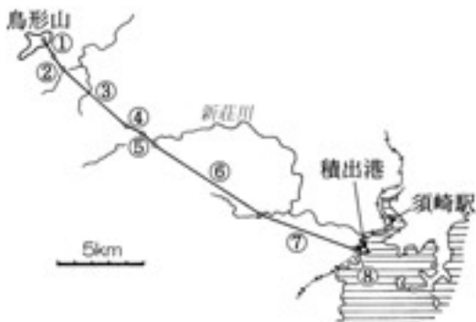
第7図 鳥形山から須崎港へ。①から⑧まで8本のベルトコンベアで鉱山と須崎事業所が結ばれている。
