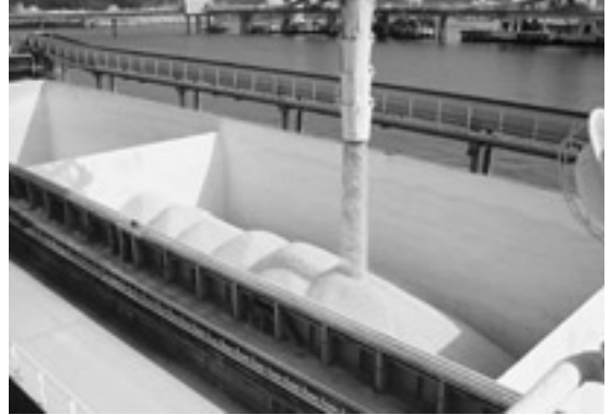
写真18 シップローダーによるバージへの積み込み。
