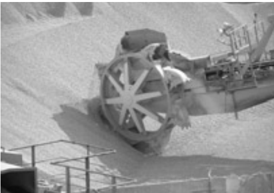
写真17 石灰石を積み込むリクレーマー。
