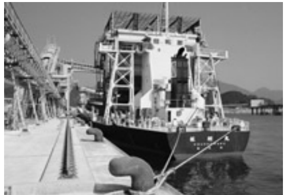
写真19 動力船「鋳翔丸」。大型バージの後部に接続・一体化し、大型輸送船となる。
