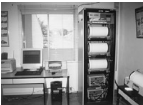
第24図 ピナツボ火山観測所の観測室。 この部屋からは、ピナツボ火山が正面に見えます。かつては窓枠には、ピナツボ火山の噴煙の高さを簡単に測定するための物差しが貼ってありましたが、外されていました。右側にはJICAの資金で設置された地震の記録装置があります。機器は日本製ではありません。2000年撮影。
