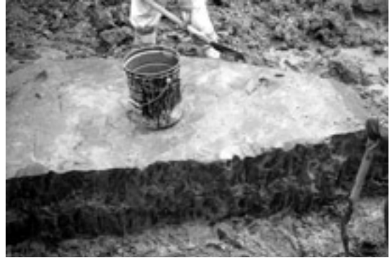
写真8 「ひよせ」粘土層。厚さ40cmほどの粘土層が人手をかけて丁寧に採掘されている。
