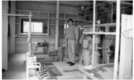
写真10 (有)備前粘土での水篩作業。工場地下に設置された水槽を使い、粘土中の砂やゴミが除去される。
