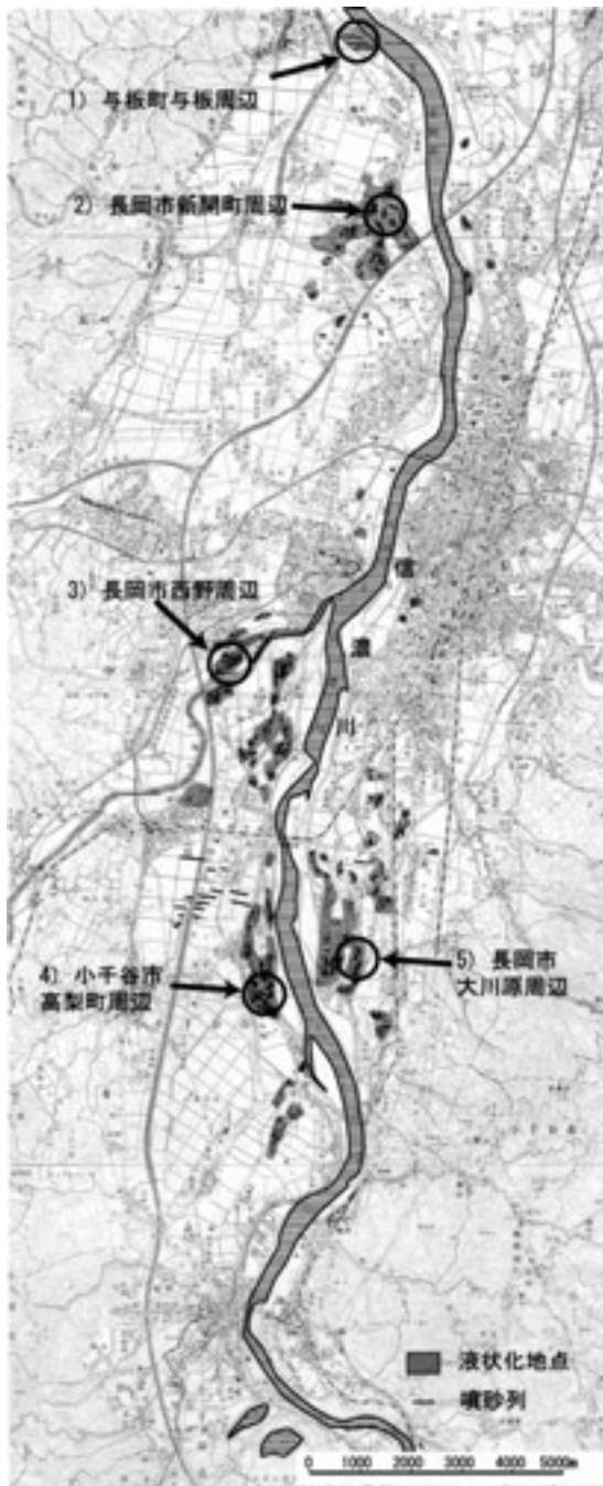
第1図 空中写真から判読した液状化地点(空中写真は、地震後、国土地理院撮影のものと同国際航業撮影のものを利用した)。
