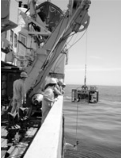
第3図 グラブ採泥器の投入作業. 第2白嶺丸による航海 (GH04) で着水前の様子.
