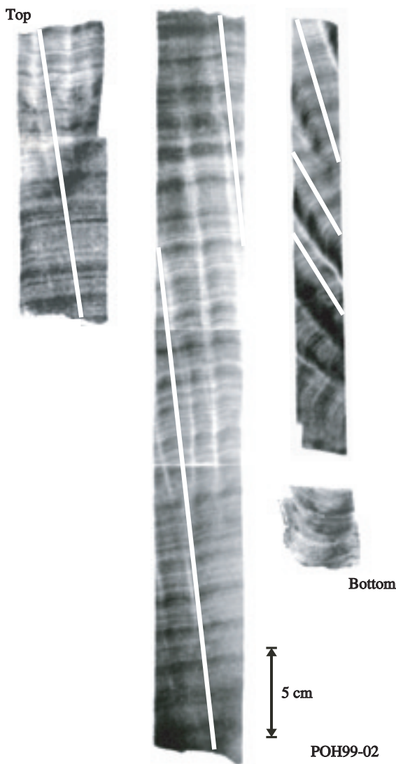
第2図 本研究で用いたサンゴ骨格試料( Porites sp.)の軟X線写真。写真中の白線は、微小試料採取用の測線を示している。
