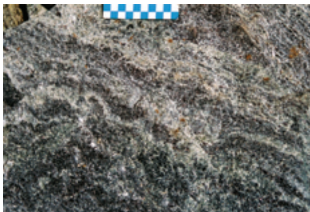
6. グラニユライト帯のざくろ石-堇青石-黒雲母片麻岩。Kudalにて、パーアルミナスであるが、帯磁率は 68.2\sim 98.5\times 10^{-3}\text{SI} であり、著しく磁鉄鉱に富んでいる。
