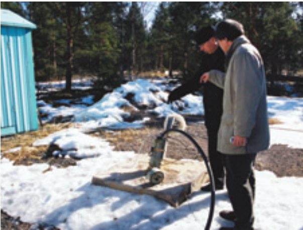
7. 高レベル放射性廃棄物処分施設建設のための調査ボーリング孔。
