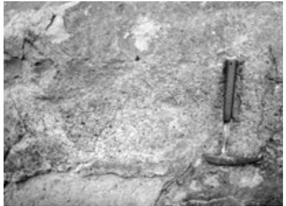
第5図 真岡鉄道茂木駅近くに分布する砂質凝灰岩。粗粒部は礎石に岩相が似ている。
