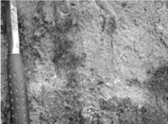
第6図 河内郡河内町，ニューセントラルゴルフクラブ入口付近に分布する砂質凝灰岩。全体に淡緑色に変質しており，砂粒が多く，礎石に岩相が良く似ている。
