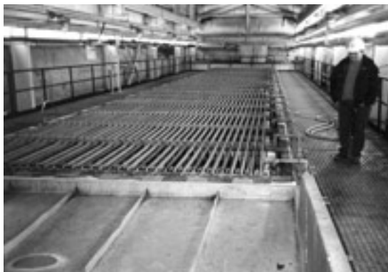
写真3 エルデネット鉱山におけるSX-EW法による銅製錬施設(2003年2月)。
