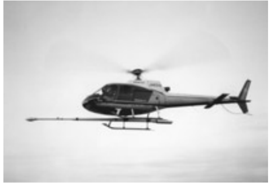
第5図 スティンガーマウント方式高分解能空中磁気・放射能探査(平成9年1月国内で初めて実施された)。
