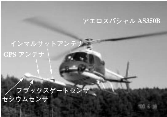
写真1 有珠火山地域の空中磁気探査に使用した調査ヘリコプター。
