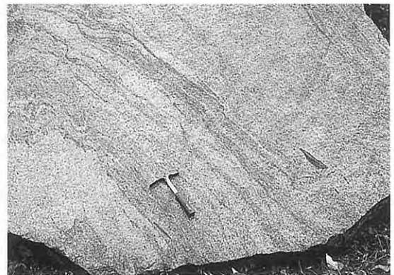
写真10 縞状構造を呈する中粒両雲母モンゾ花崗岩(中根石材採石場)。
