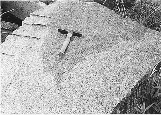
写真7 細粒黒雲母花崗閃緑岩を貫く中粒黒雲母花崗閃緑岩(山仙石材採石場)。
