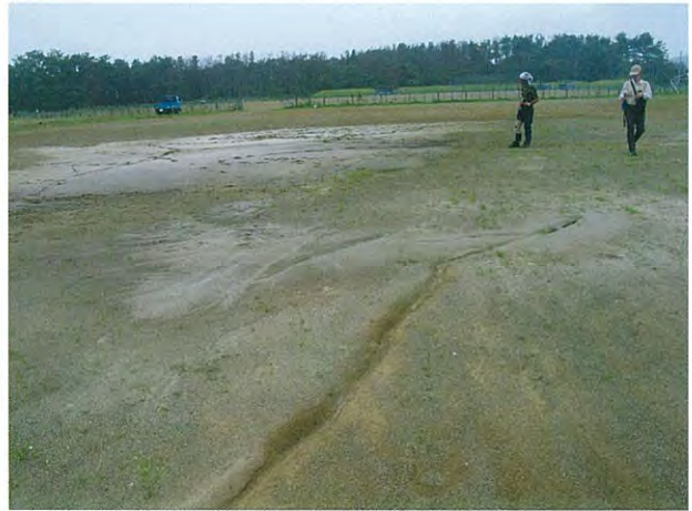
2. 噴砂丘とその中央部に形成された噴砂亀裂(鳴瀬町浜市の東部運動公園).
