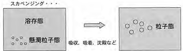
第4図 スカベンジングの模式図。
