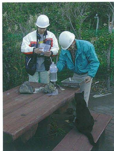
3. 火山灰採取用トレーのメンテナンス作業の様子。前回の設置以後にたまった火山灰を回収し、トレーを洗浄して再び設置する。回収した火山灰は実験室に持ち帰り、分析に用いられる。
