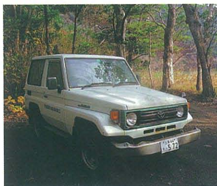
4. 島内で使用している車は、火山ガスや酸性雨の影響のためか変色や腐食が著しい。フロントグリルは緑色に変色し、ワイパーはたびたび故障する。
