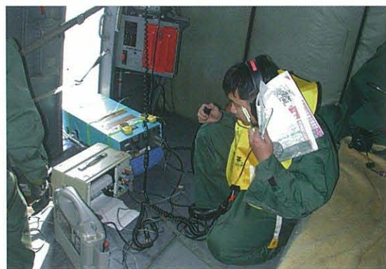
7. それまで別フライトで行われていたCOSPECによる二酸化硫黄ガス観測も、2001年11月から火口観測と同じフライトで行うようになった。水色の機械がCOSPEC本体。ドアを開けてセンサー部分を機外に出して観測する(2002年2月6日 東宮撮影)。
