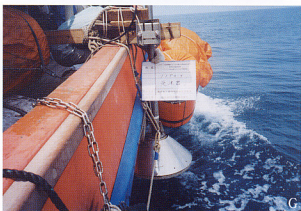
第4図 ソノブローブ音波探査の作業風景。 D) 積装した調査船の全景。E) 船内における音響断面図の出力作業。F) 積装されたソノブローブ送波器。G) 積装されたソノブローブ受波器。
