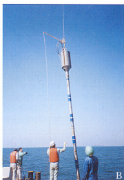
第3図 台船を足場とした柱状コア試料の採取作業。 A) 積装した台船の全景。 B) 重力式採泥器による柱状コア試料の採取作業。 C) ロータリーボーリングによる長尺不攪乱コア試料の採取作業。トリプルコアチューブによるワイヤーライン工法を用いた。
