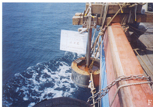
第4図 ソノブローブ音波探査の作業風景。 D) 積装した調査船の全景。E) 船内における音響断面図の出力作業。F) 積装されたソノブローブ送波器。G) 積装されたソノブローブ受波器。
