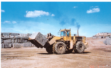
2. ドリル法で巨大ブロックを切り出し搬出する。
