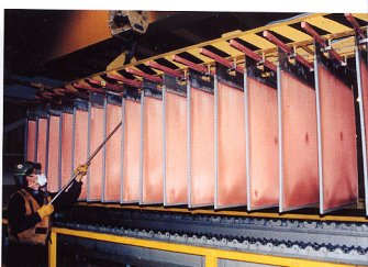
10. トケバラ鉱山における電気分解後の最終製品の銅板。
