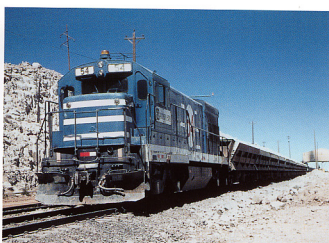
7. カホネ鉱山の鉱石運搬。ディーゼル鉱車で鉱石を粉砕室に運び込む。
