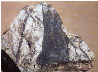
2. セロ ウェルデの網状二次富化鉱石、左右21cm。初生銅鉱物が暗灰色の輝銅鉱に変質、黄色斑点は残存する黄鉄鉱。
