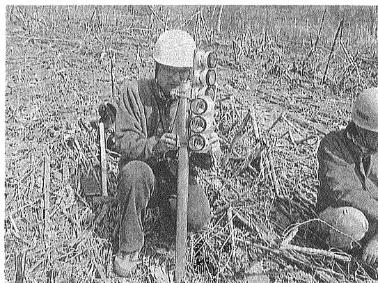
写真7 高速道路の山側斜面に光波測距用の反射ミラーを設置しているところ(斎藤)。
