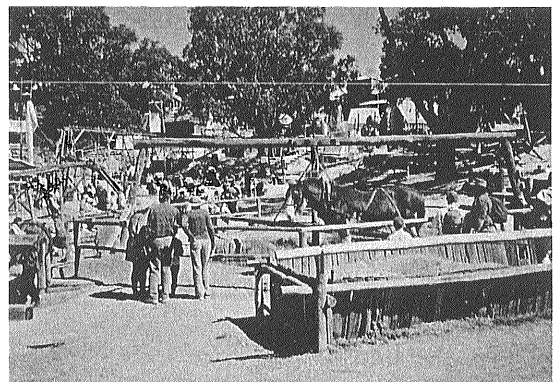
写真1 パドリングマシーン(かくはん機)と中に繋がれている馬(ソブリン・ヒル)。
