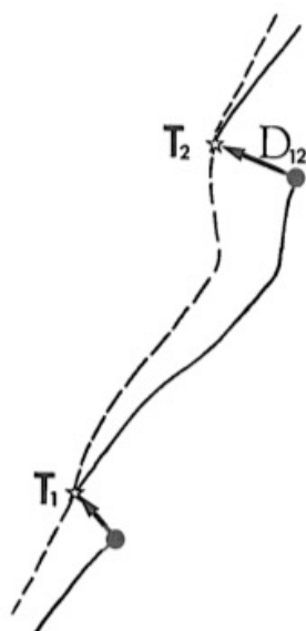
第2図 updateと実時間船位・再計算船位(石原, 1977). 航法装置から得られる実時間船位(実線)では衛星測位の位置(星印)が得られるごとにupdateと呼ばれる推測航法の位置(黒丸)からの跳びが発生する. 時刻 T_2 のupdateの跳びのベクトル D_{12} を一つ前の衛星測位からの時間差 T_2-T_1 で割って海水の流れのベクトルの修正量を計算し, それを T_1 から時間で積分して T_1 から T_2 までの修正位置(再計算船位; 破線)を求める.
