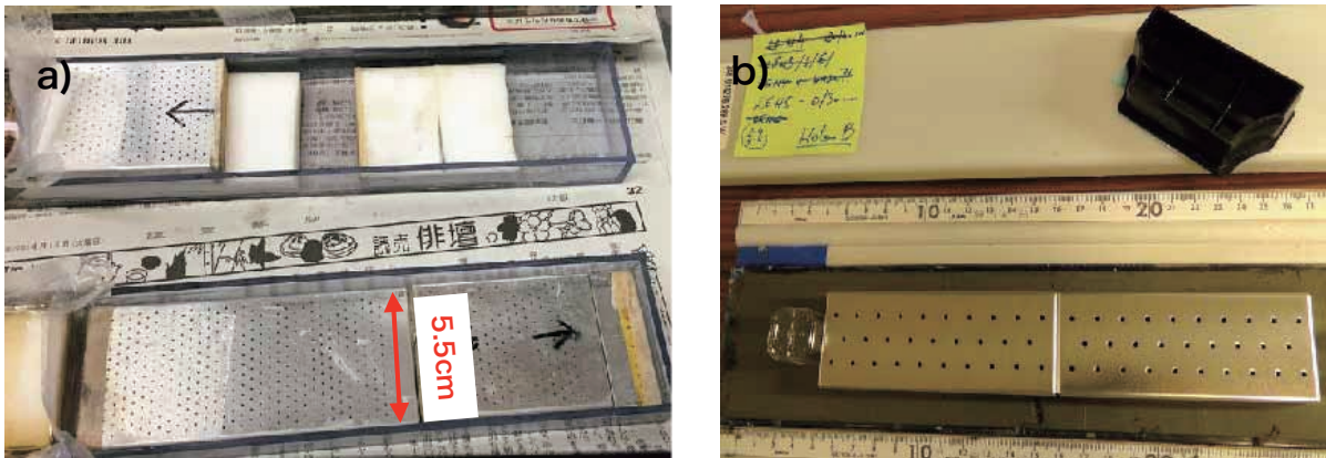
第3図 a) 今回用いたアルミ型枠. b) 海外製のアルミ型枠. Fig. 3 a) Aluminum sampling tool used in this study. b) Another aluminum sampling tool used in abroad.
