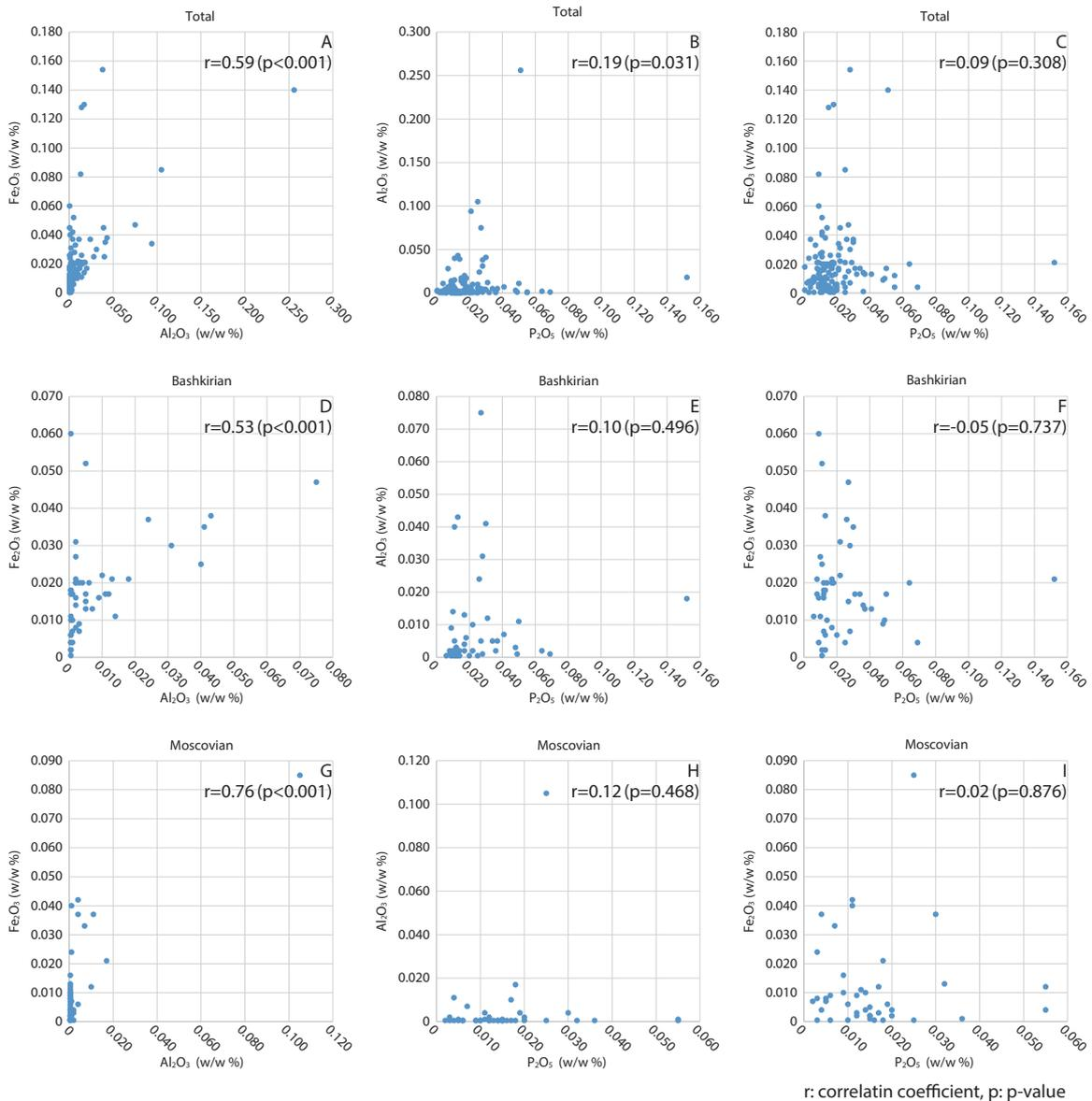
第7図 Al<sub>2</sub>O<sub>3</sub>, Fe<sub>2</sub>O<sub>3</sub>, P<sub>2</sub>O<sub>5</sub>の相関図.
