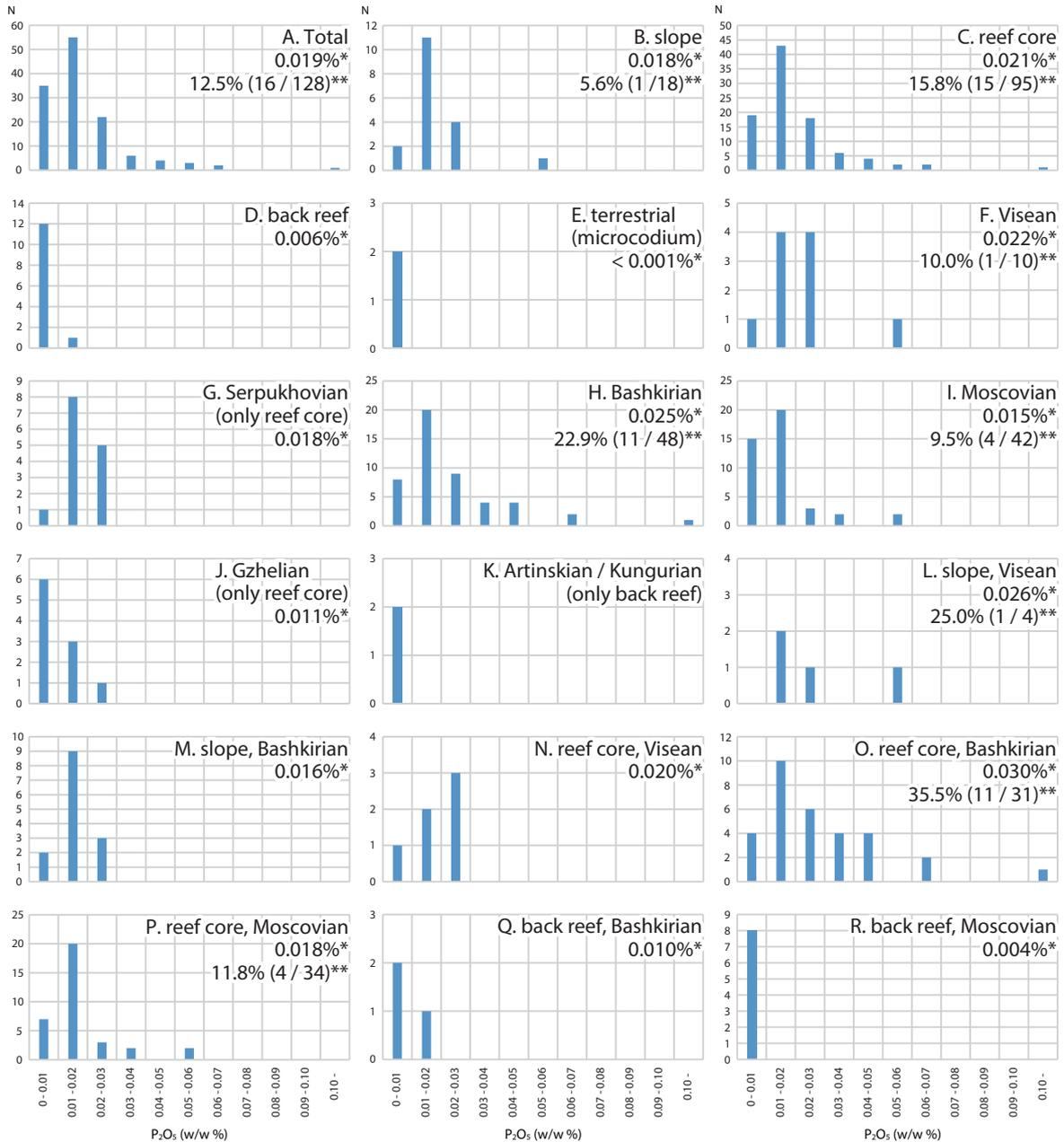
第4図 堆積環境・年代別のP<sub>2</sub>O<sub>5</sub>の含有量のヒストグラム。\*は平均値、\*\*は0.03%を超える試料の割合(%)を示す。
