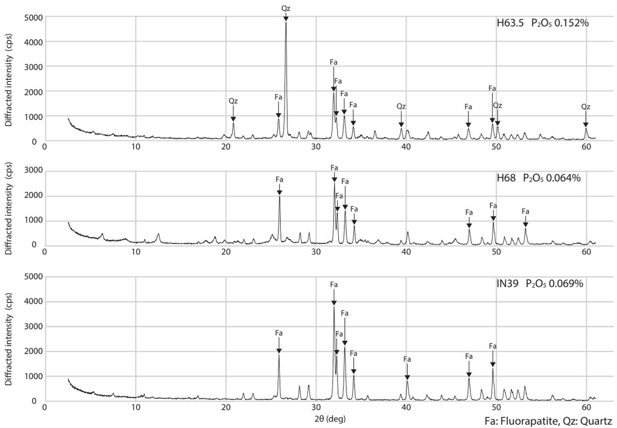
第6図 試料H63.5, H68及びIN39のX線回折パターン.
