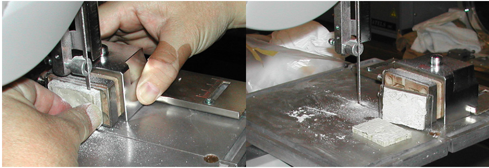
第3図 バンドソーでスライドガラスに接着した試料を100 µmに切断する。右の写真は切断後の試料。 Fig. 3 Slicing of a sample by using a band saw to obtain 100 µm thickness slices while keeping the sample dry. Right side photograph shows 100 µm thickness sample retained on the glass slide.
