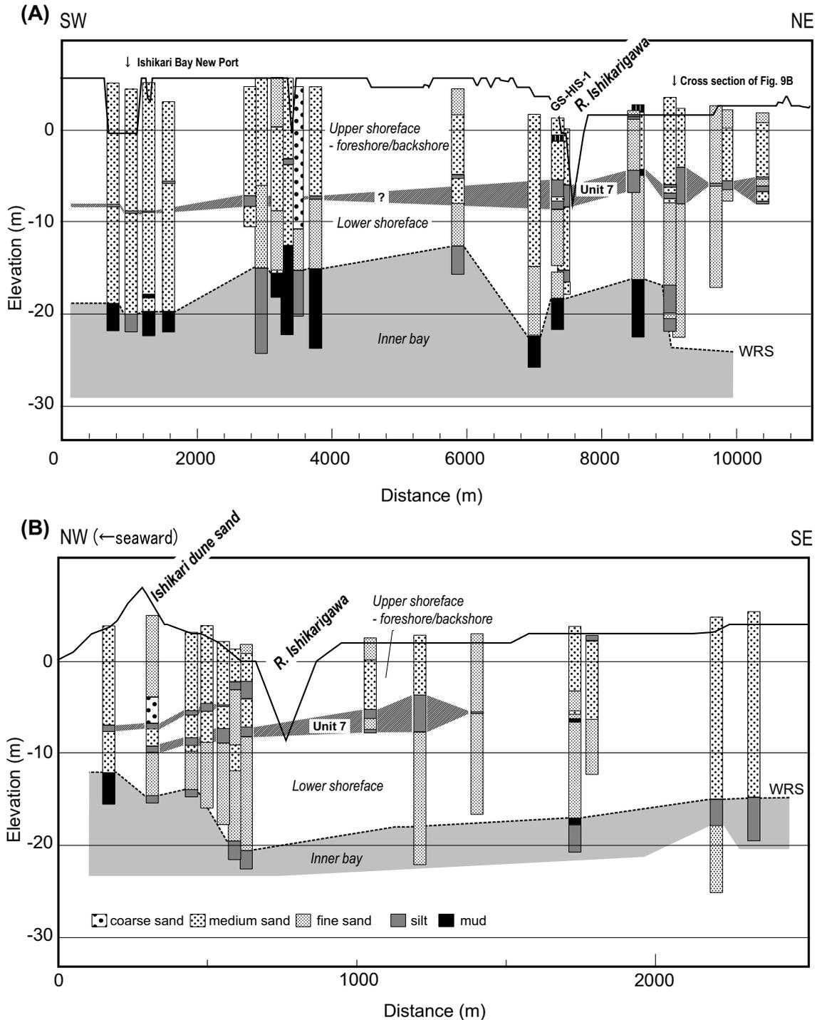
第9図 石狩川河口域における地盤ボーリング柱状図の対比 (測線位置は第1図参照)。
