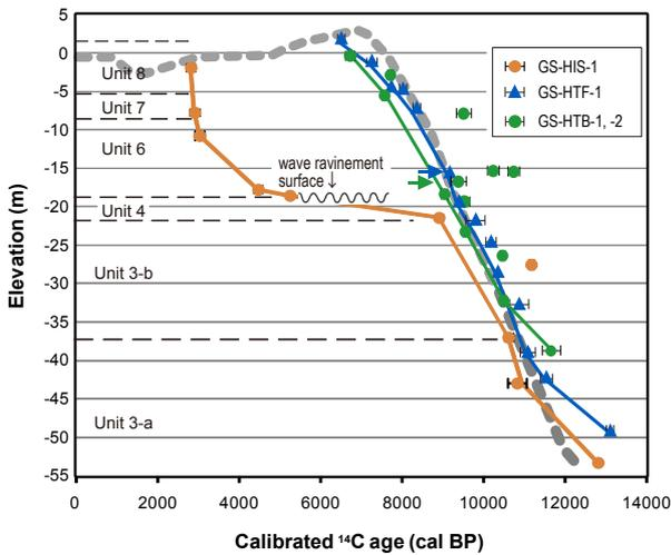
第8図 GS-HIS-1 コアの堆積曲線。比較のため、GS-HTB-1, -2 コア及びGS-HTF-1 コアから求めた堆積曲線を合わせて示し、緑と青の矢印でユニット3とユニット4の境界位置を示した。灰色の破線は木村ほか(2006)がコンパイルした奥東京湾における海水準変動曲線。年代値の誤差は2σの範囲を示す。
