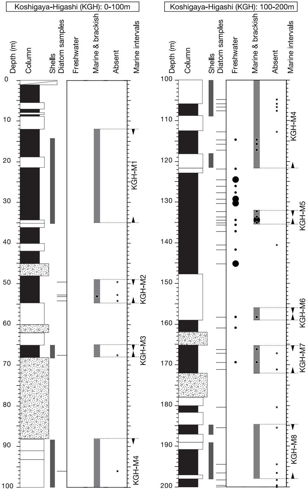
第5図A 越谷東コア(KGH)の柱状図, 貝化石産出深度, 珪藻化石分析深度, 珪藻化石産出頻度と海成層深度(深度0-200m).
