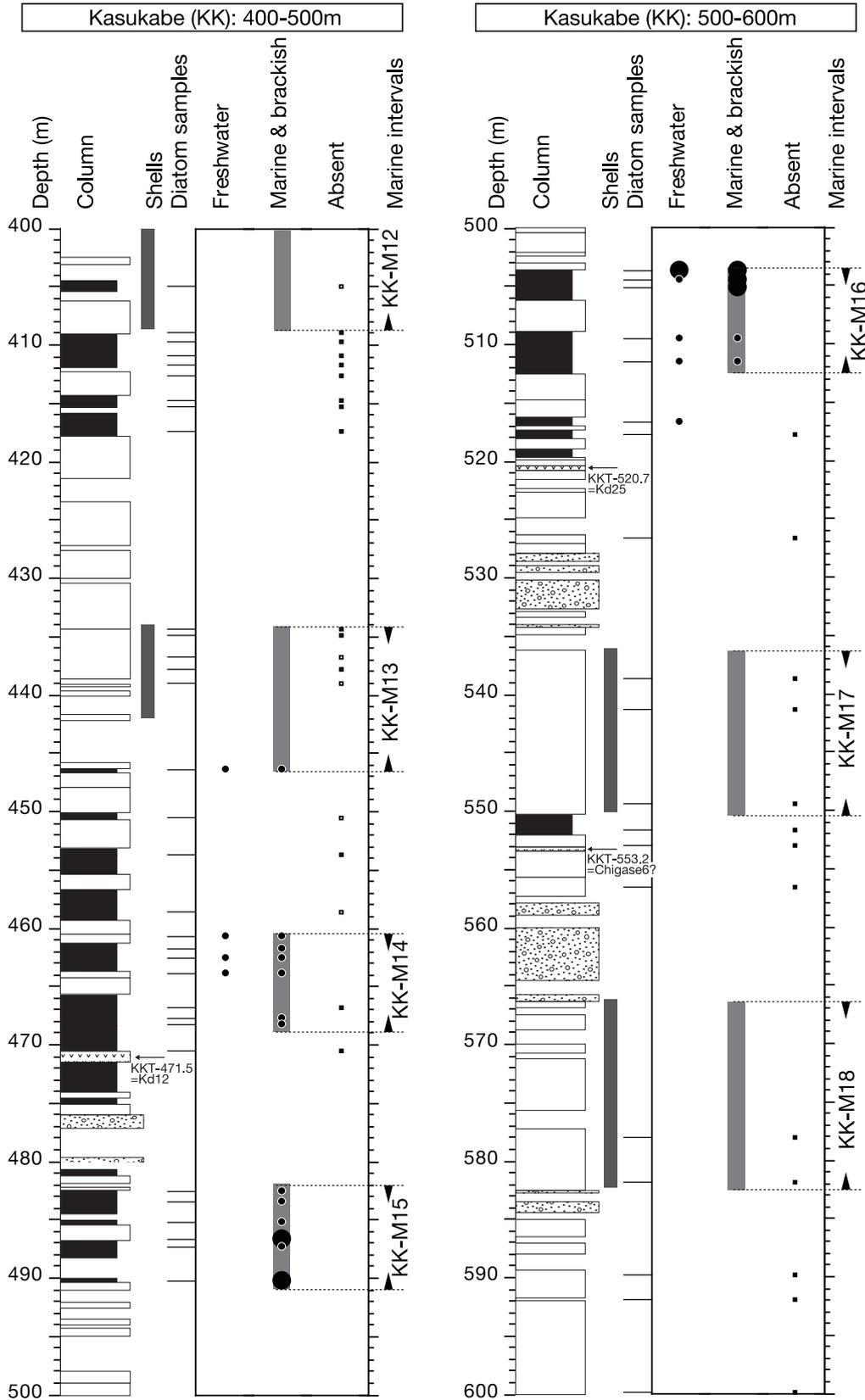
第7図C 春日部コア(KK)の柱状図, 貝化石産出深度, 珪藻化石分析深度, 珪藻化石産出頻度と海成層深度(深度400-600m).
