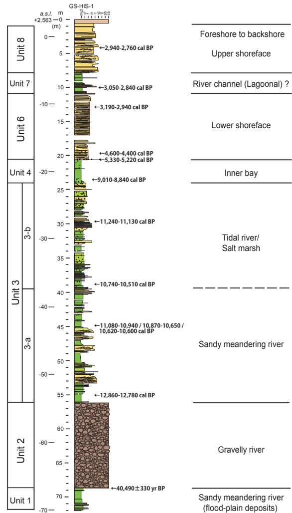
第 7 図 GS-HIS-1 コアの層序ユニットと AMS  $^{14}\text{C}$  年代、及び解釈された堆積環境。柱状図の凡例は第 2 図を参照。
