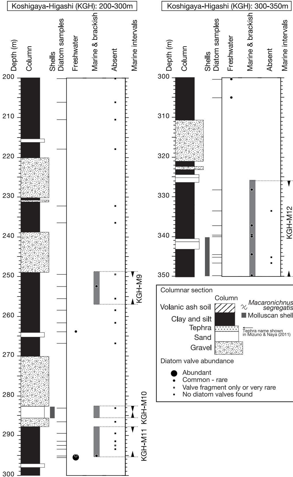
第5図B 越谷東コア (KGH) の柱状図, 貝化石産出深度, 珪藻化石分析深度, 珪藻化石産出頻度と海成層深度 (深度 200-350 m).
