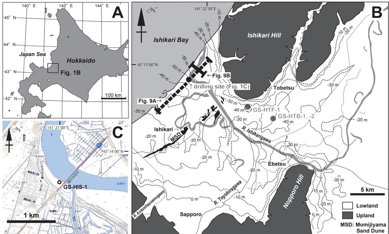
第 1 図 GS-HIS-1 コアの掘削地点位置図. 第 1 図 B のコンター (細い破線) は石狩平野における基底礫層上面深度 (標高) の等値線 (廣瀬ほか, 2011), 黒色の太い波線は第 9 図の断面線を示す. 第 1 図 B の地形図は国土地理院が公開する電子国土を用いた.
