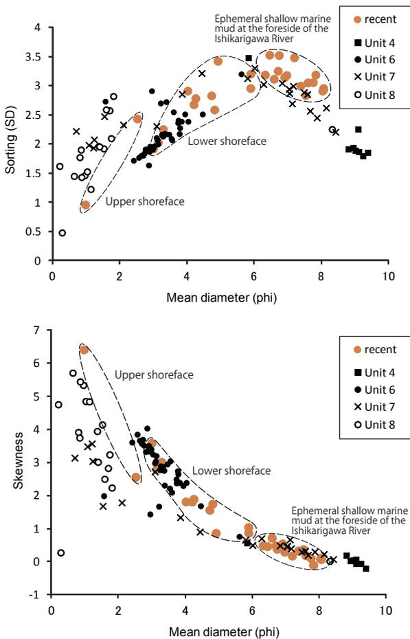
第6図 GS-HIS-1 コアの堆積物と石狩湾の現世表層堆積物との粒度特性の比較。(A) 平均粒径—淘汰度(標準偏差)図及び(B) 平均粒径—歪み度図。
