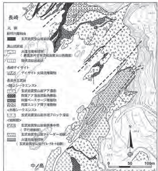
第10図 きららかホテル北方の海食台における長楽寺玄武岩の岩相分布図。
