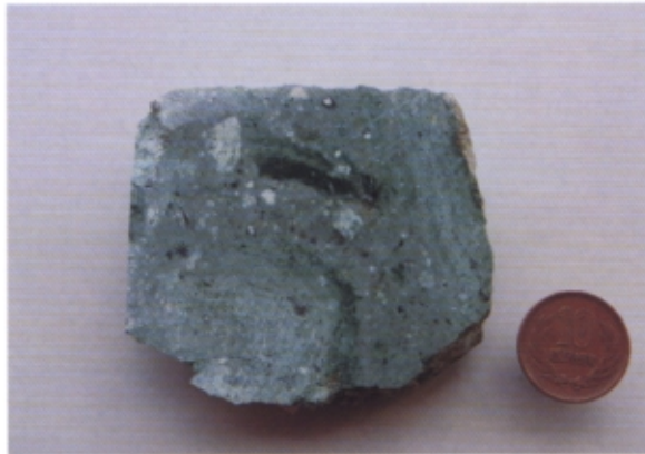
第12図 (b) 試料番号：95071211, 採取地：三島町浅岐. 地熱系外のイライト・緑泥石帯の流紋岩質火山礫凝灰岩. 同質岩片を多数含み, 細粒部は強く緑泥石化する. Fig. 12 (b) Regionally altered rhyolitic lapilli tuff from illite chlorite zone, Asamata, Mishima town (#95071211).
