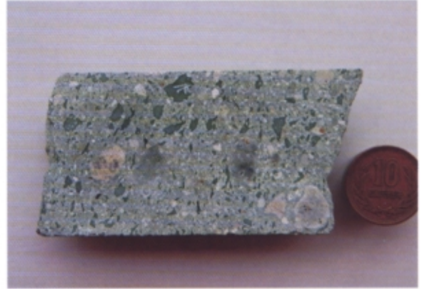
第12図 (d) 試料番号：OA1-998, 採取地：坑井N57-OA-1, 深度998.0m. 地熱系内(地層温度約130°C)のイライト・緑泥石帯の流紋岩質火山礫凝灰岩. Fig. 12 (d) Altered rhyolitic lapilli tuff from illite chlorite zone in present geothermal system (130°C logged), GL -998.0m in well N57-OA1.
