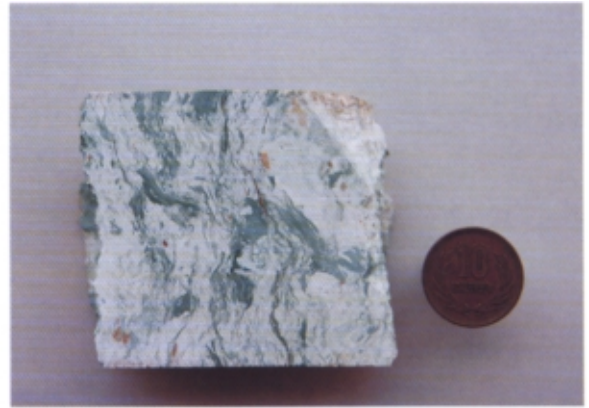
第12図 (f) 試料番号：4r-650, 採取地：坑井84N-4r, 深度650.0m. 地熱系内(地層温度約150°C)のイライト・緑泥石+帯の流紋岩質軽石凝灰岩. Fig. 12 (f) Altered rhyolitic pumice tuff from illite chlorite+ zone in present geothermal system (150°C logged), GL -650.0m in well 84N-4r.
