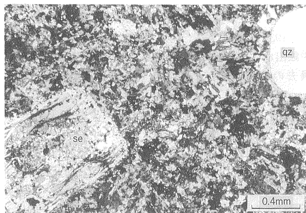
第3図 年代測定試料96102201, 北見鉱山産変質石英斑岩。黒雲母と思われる残斑晶 (se)及び石基全般が絹雲母化, 方解石化変質を受ける。qzは石英。
