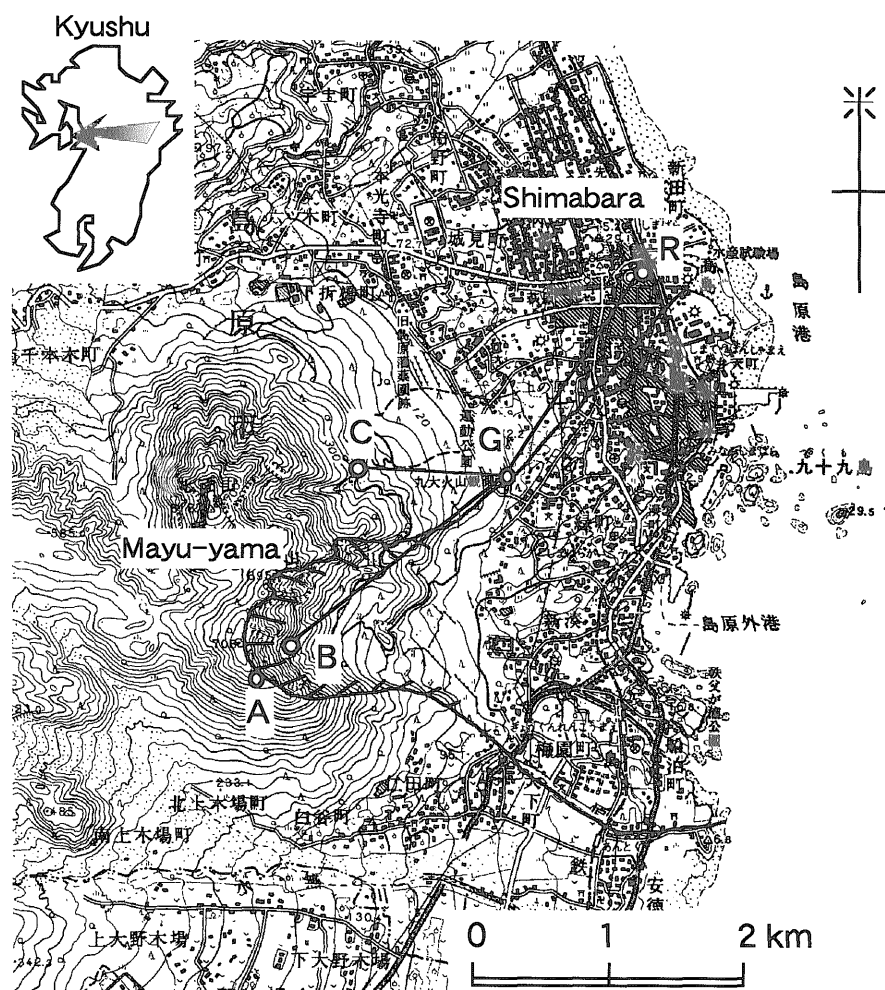
第1図 眉山の地形と光波測距観測線。実線は1792年の崩壊および堆積域、G: 光波測距システム設置点、A, B, C, R: 反射鏡設置点。地形図は国土地理院発行の5万分の1地形図「島原」を使用。
