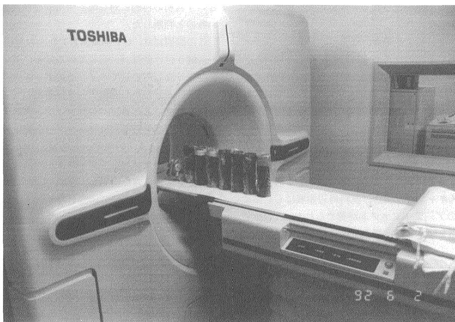
第2図 医療用X線CT装置でのコア撮像の様子 通常被験者が仰臥する寝台上にコアを並べ、寝台をスライドさせて各コアの中心線を通る位置で断面像を撮る。
