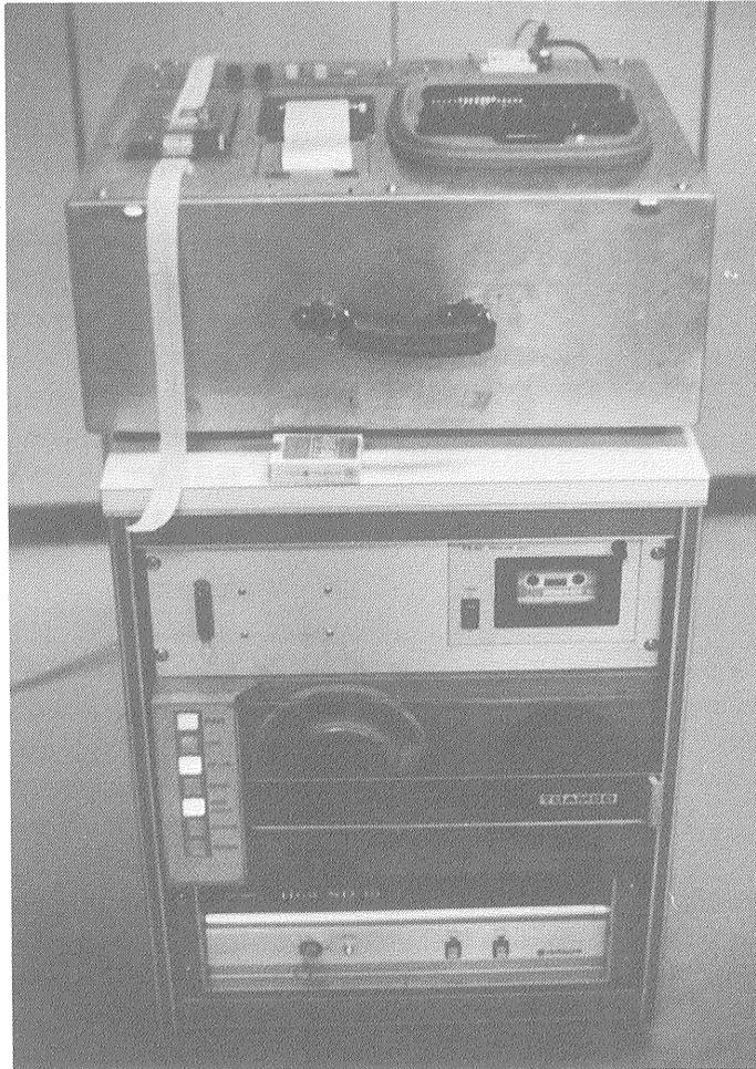
第14図 現在の磁気テープデータ再生処理装置
