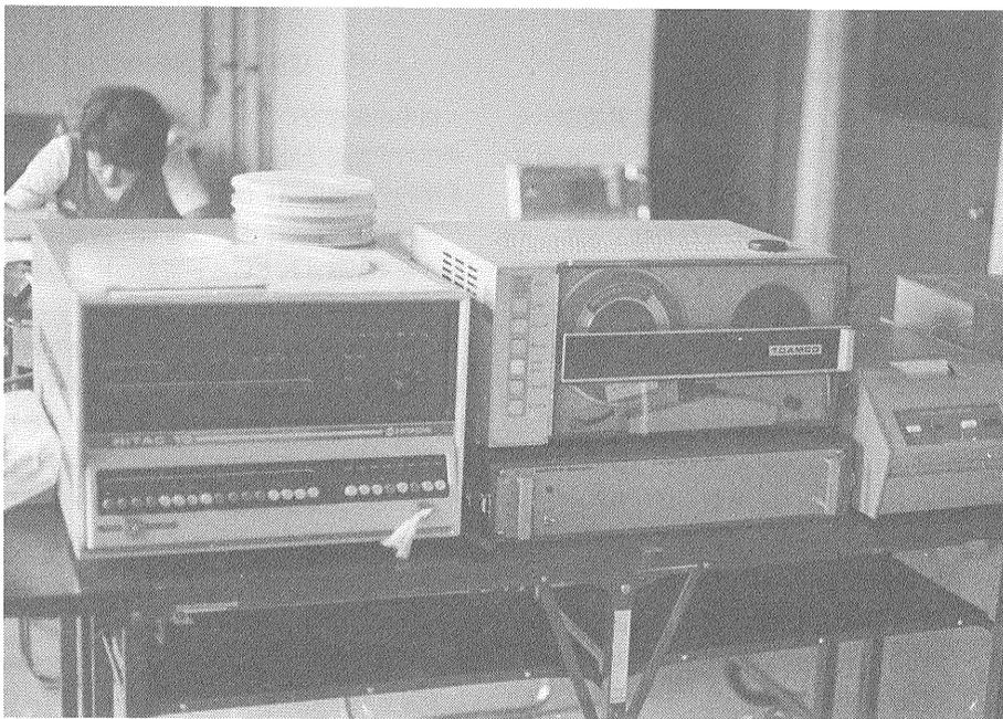
第11図 初期の磁気テープデータ再生処理装置
