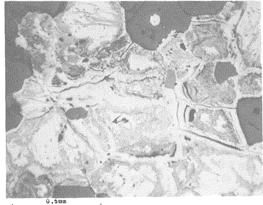
第4図 萬黒鉱床, 著しい酸化をうける磁硫鉄鉱 (単ニコル), (K-107B)
