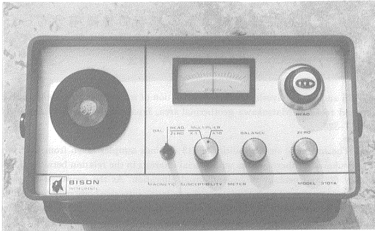
第1図 バイソン社製3101A型帯磁率計 左側の円筒形の試料容器にカッティングス試料を入れた状態を示す
