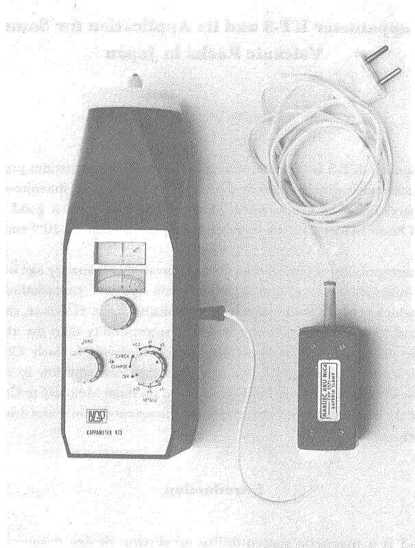
Fig. 1 Kappameter KT-3 (After IAG, 1971).
