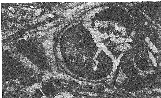
3. C-50. 碎屑貝類内は亮晶をもっている泥晶石灰岩 貝殻内とそのまわりは黒色と灰黒色のピチューメン(オープンニコル, ×16)
