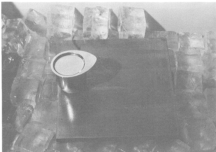
第9図 赤熱状態の白金合金るつぼを素焼板の上で赤味のとれるまで、冷却ののち、氷上のステンレス板にのせて、急冷する。
