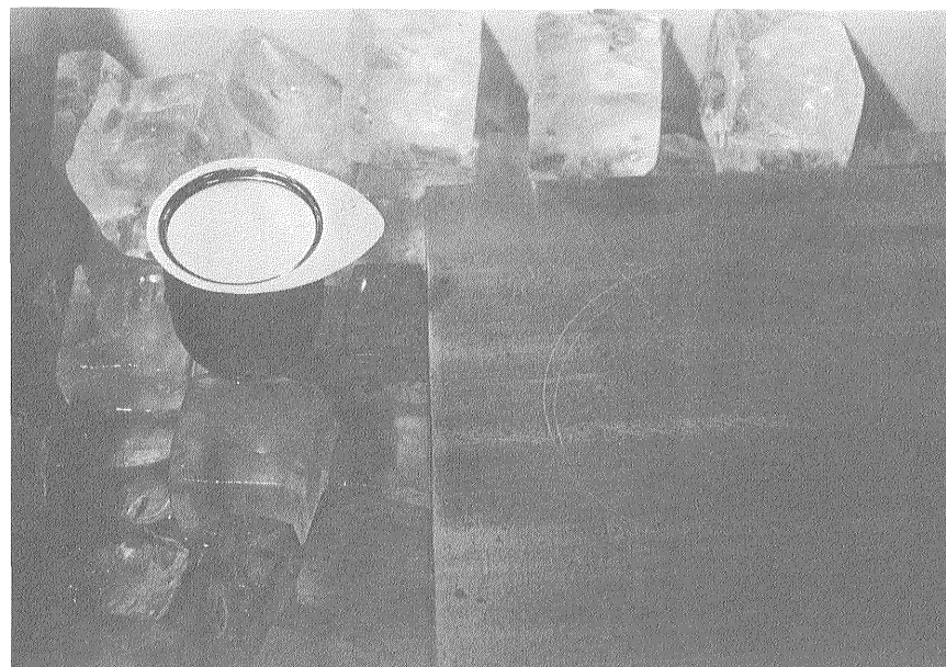
第10図 冷却後、るつぼのふたに軽く触れるほど冷えたるつぼを直接氷の上にのせた状態
