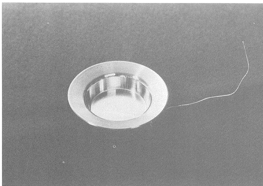
第2図 成型用白金合金ざら Crucible for moulding, exclusively used on a borax bead machine.
